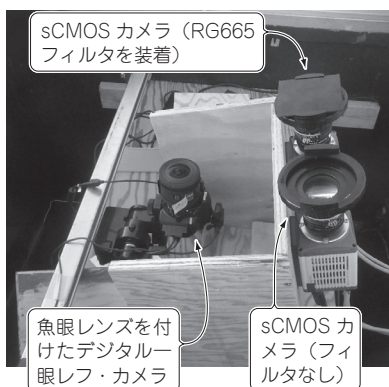
写真1 アラスカのボーカフラット実験場に設置した魚眼カメラとsCMOSカメラ 魚眼レンズを付けたデジタル一眼レフ・カメラで空にオーロラが出ているかどうかを監視し、オーロラがあるとだけsCMOSカメラで高速撮像を開始する。RG665フィルタを通すと、オーロラ発光のうち特定数の長い緑色（波長は557.7nm、特定数は0.7秒）と赤色（波長は630.0nm、特定数は110秒）のオーロラ輝線を消すことができ、速い変化だけを強調した画像を得られる。BG3フィルタは、RG665と同様に緑色と赤色をカットするが、RG665と違って青色（波長は427.8nm）も通す
