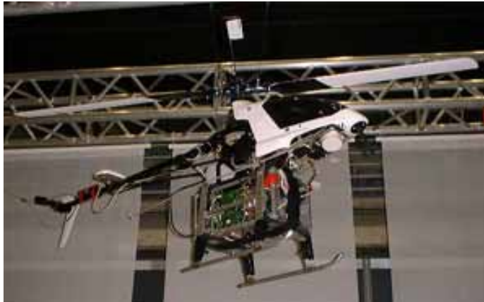
機種名:SST-Eagle GS 全備重量:8.5Kg ローター径:1.65m
