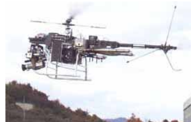
機種名:SF86 全備重量:42.0Kg ローター径:2.5m
