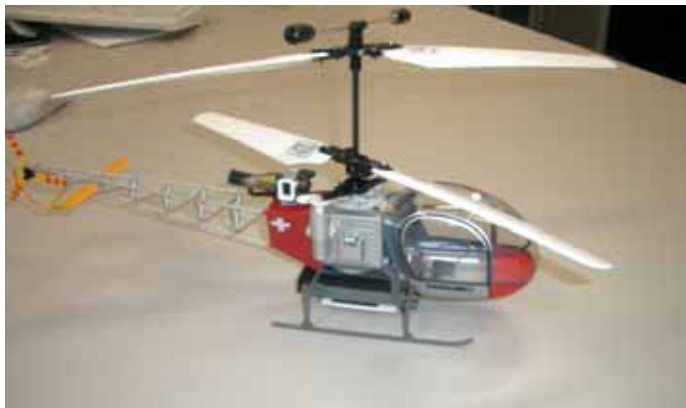
機種名:XRB-SR-Lama 全備重量:195g ローター径:350mm
