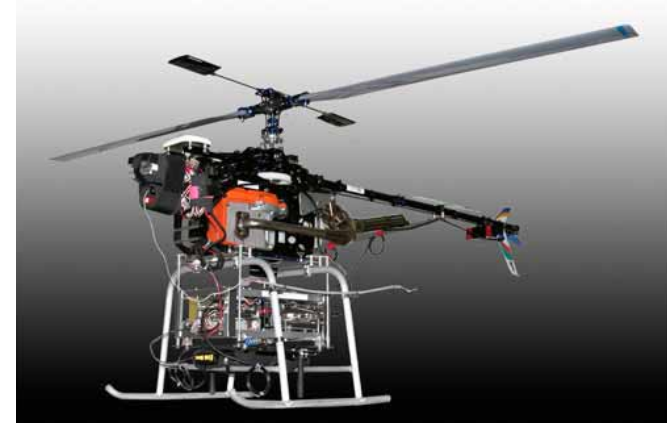
機種名:SF40 全備重量:17.5Kg ローター径:1.85m
