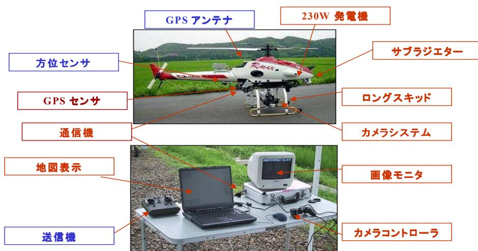
図6 高高度 RMAX のシステム構成
