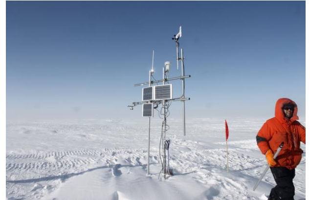
図 1 2018 年 10 月に南極氷床上の中継拠点に設置した AWS. 気温, 湿度, 気圧, 風向・風速, 積雪深, 雪温(深度: 7m, 5m, 3m, 1m, 0.5m)を計測する.
